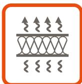
Perméable à la vapeur d'eau (**Sd < 0,11 m**), TS-LIN peut se poser seul ou au contact d'un isolant fibreux, existant ou non, **sans risque de condensation.**
